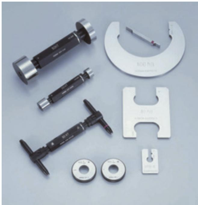
穴と軸の互換性を確保するために必要なゲージです。穴または軸の最大許容寸法を基準とした測定端面と、最小許容寸法を基準とした測定端面を持ったゲージです。
